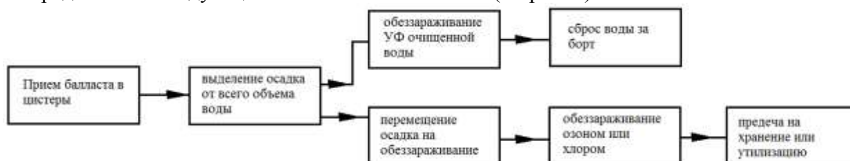
Рис. 3 Технологическая схема процесса очистки и обеззараживания балластной воды
