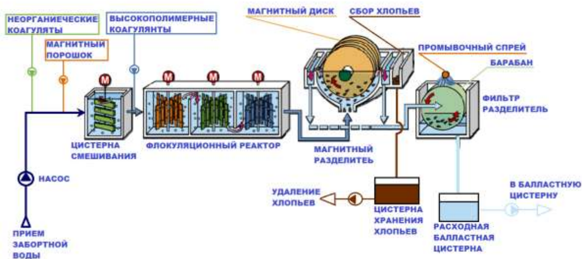
Рис. 1 Схема процесса очистки балластной воды установкой Hitachi Clear Ballast System
